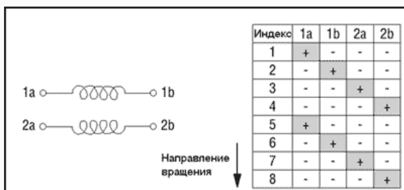
Рис.3. Управляющая последовательность для режима с единичным шагом.
