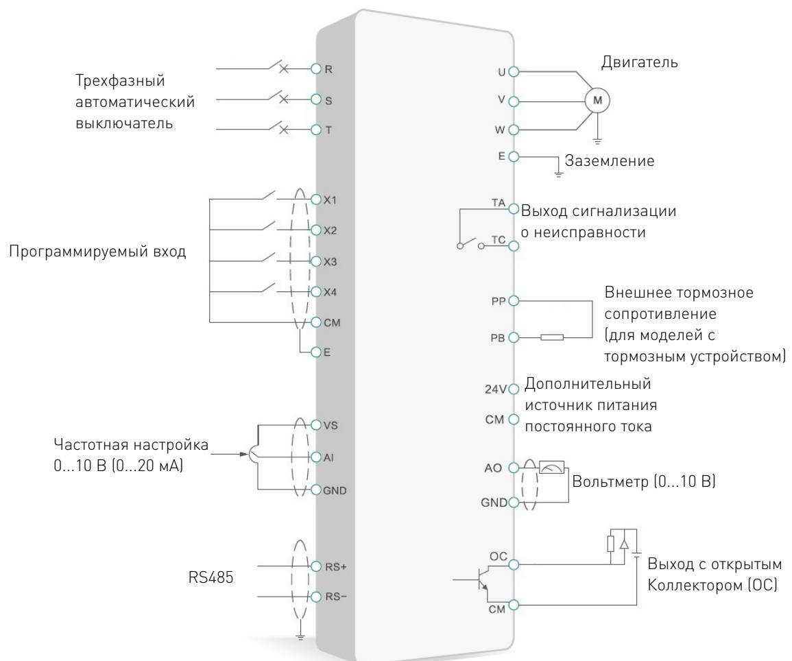
Рисунок 1 – Типовая схема подключения частотного преобразователя DL100.
