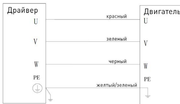
Рисунок 4 – Схема подключения питания силовой части драйвера.
