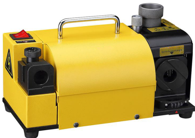
Рисунок 3 – Внешний вид заточного станка MR-13A и вид заточки.
